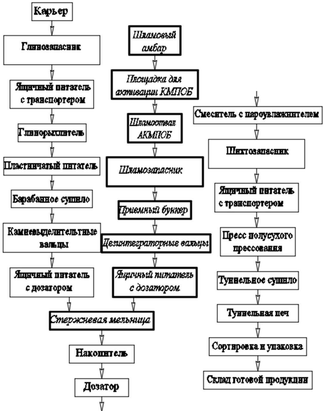
Рисунок 1 – Технологический процесс производства керамического кирпича
