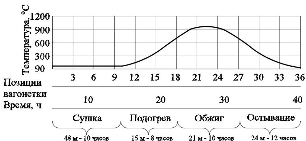
Рисунок 5.3 – Температурная кривая в двухканальной печи–сушилке
